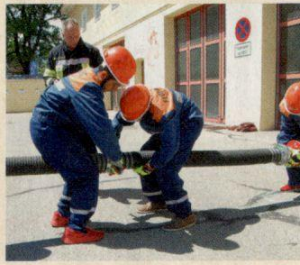
Zwei Saugschläuche müssen zusammengekuppelt werden. Die beiden Kupplungen müssen auf gleicher Höhe gehalten werden.
